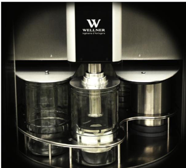
Alle Reinigungsbaden sowie die Trocknungsfunktion können als einzelne Schritte in beliebiger Reihenfolge und Anzahl programmiert und durchlaufen werden, wobei bei jedem Schritte die Art der Reinigungsbe-
