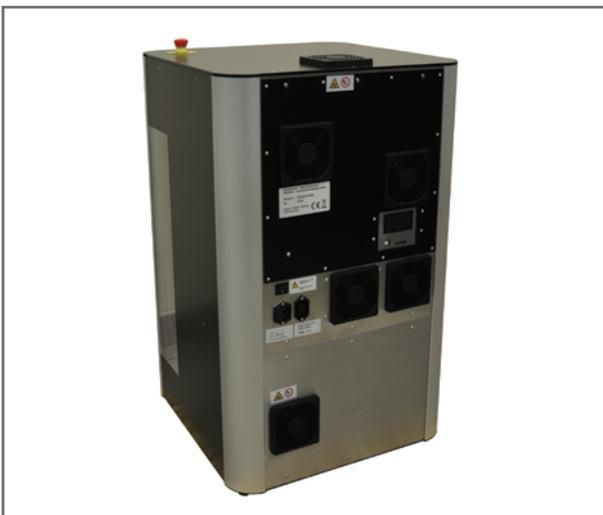
Die gesamte Leistungselektronik sowie die SPS befindet sich abgetrennt vom Arbeitsraum in einem separaten Schaltkasten der nach außen zwangsbelüftet ist. Das Heizgebläse befindet sich über den Flüssigkeiten und saugt von außen Frischluft an. Heizung, Arbeitsraum und Schaltschrank sind temperaturüberwacht. Eine Türüberwachung stoppt alle Achsen, wenn die Tür im laufenden Betrieb geöffnet wird.
