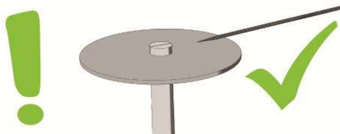
**Arbeiten Sie immer mit einer gut angeschliffenen Elektrode!**
