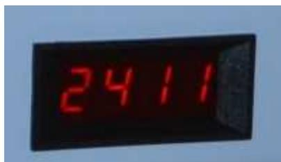
Die 4-stellige LED – Anzeige gibt die eingestellte Drehzahl in U/min an. Die Regulierung der Drehzahl erfolgt stufenlos durch Drehen des Drehknopfes im Uhrzeigersinn. (Siehe Bedienfeld Seite 9, Regler Nr. 4)
