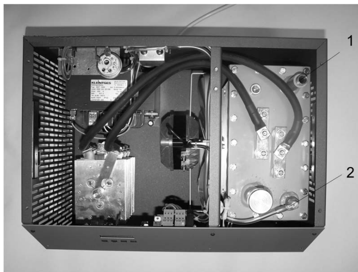
Abb. 3: Lötstar 301 Ansicht von oben ohne Gehäusedeckel 1 – Ausgang zum Oberteil: Kunststoff-Verschlussmutter entfernt 2 – Kunststoff-Verschlussmutter entfernt und Messanschluss montiert
