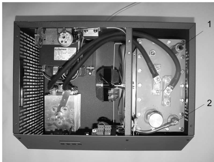
Abb. 3: Lötstar 241 Ansicht von oben ohne Gehäusedeckel 1 – Ausgang zum Oberteil: Kunststoff-Verschlussmutter entfernt 2 – Kunststoff-Verschlussmutter entfernt und Messanschluss montiert
