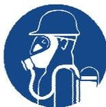
Umgebungsluftunabhängiges Atemschutzgerät tragen.
