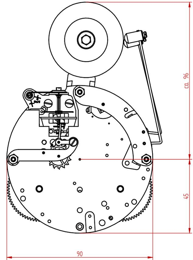
8 Tage Halbstunden Schlagwerk; Federzugwerk; Gangregler; 2 Hämmer auf Glocke
