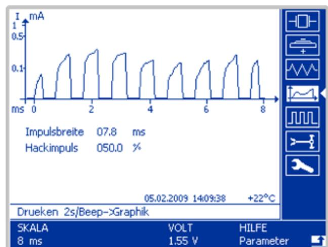
Der Stromimpuls wird als Kurve dargestellt. Die Impulsform ist ein wichtiges Aussagekriterium über das gute Funktionieren einer Uhr. Durch vergleichende Messungen mit einer guten Uhr gleichen Typs können Fehler im mechanischen Teil der Uhr festgestellt werden. Zusätzlich werden die Impulsbreite und das Hackverhältnis numerisch angezeigt.
