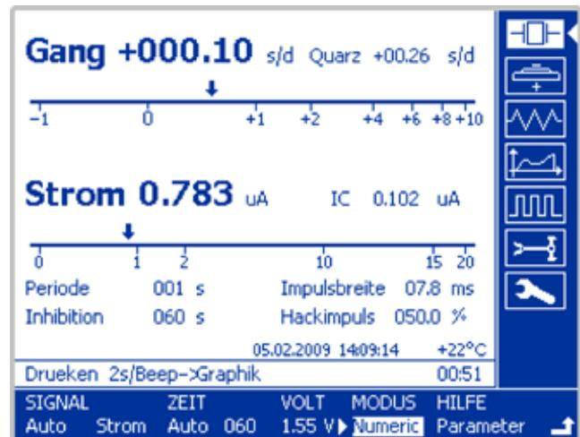
Die zu prüfende Uhr wird mit einer variablen Spannung gespeist. Die Kontaktierung erfolgt mittels beweglichen Sonden. Während der Messung können die Zeiger der Uhr mit dem eingebauten Spiegel beobachtet werden.
