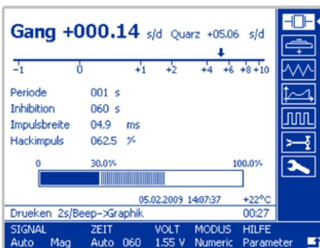
Die Analyse des magnetischen Signals ermöglicht nebst der Anzeige der Ganggenauigkeit die Messung der Periodendauer, der Impulsbreite wie auch der Inhibitionsperiode und des Hackverhältnisses. Somit kann ohne Öffnen der Uhr der Leistungsgrad des Uhrenantriebes bestimmt werden.
