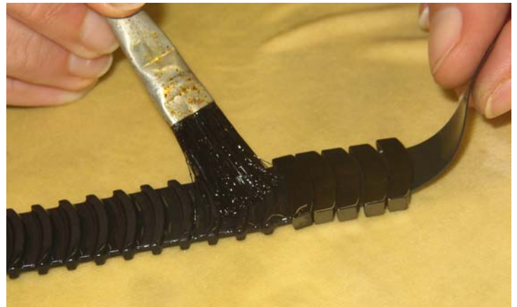
Sehne mit Silikonöl einpinseln, und Glider auf Position ziehen.
