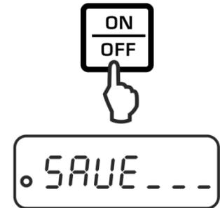
⇒ Durch Drücken der **TARE**-Taste werden die vorgenommenen Änderungen abgespeichert. Die Waage kehrt automatisch in den Wägemodus zurück.
