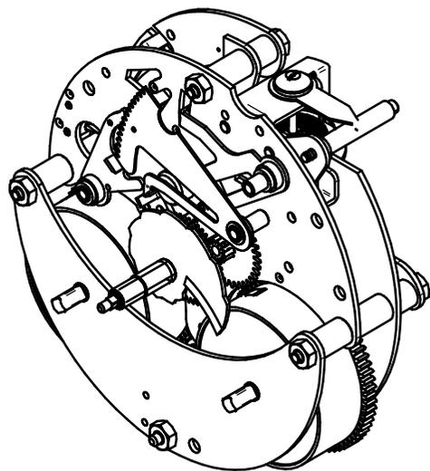
8 Tage Halbstunden Schlagwerk; Federzugwerk; Gangregler; 2 Hämmer auf Glocke
